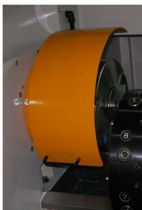
Figura 3: Esempi di meccanismi di apertura di ripari per mandrino, a sinistra a cerniera a destra a slitte
