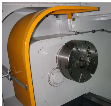
Figura 3: Esempi di meccanismi di apertura di ripari per mandrino, a sinistra a cerniera a destra a slitte
